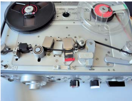
Mit eingelegtem Band: Die Bandführung ist geschlossen. Das Band wird zwischen Rubinen geführt
