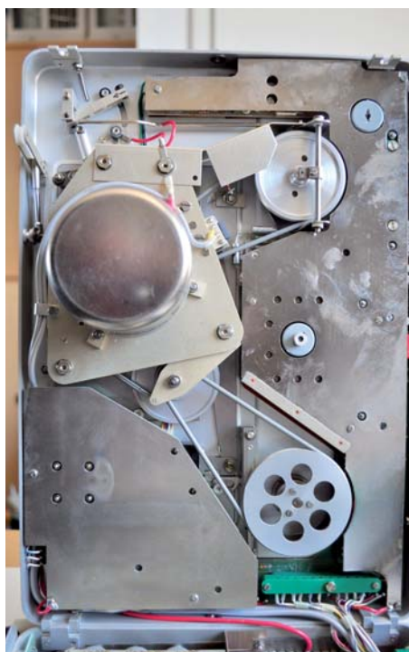
Kompakt und solide: Nagra IV-S Laufwerk von unten
