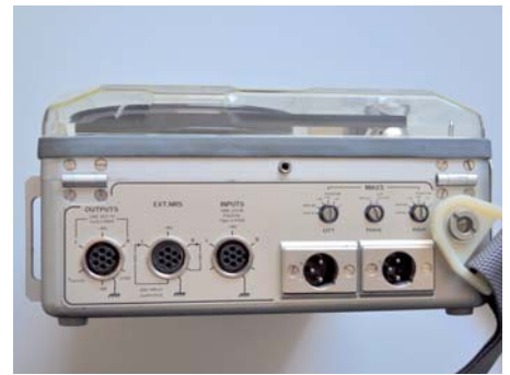
Verschraubbare Kleintuchel- und XLR-Anschlüsse für Mikro, Line und NRS (Geräuschunterdrückung)
