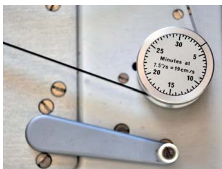
Speziell für die Geschwindigkeit 19 cm/sec ist die rechte Bandführung als kleine mechanische Uhr ausgebildet
