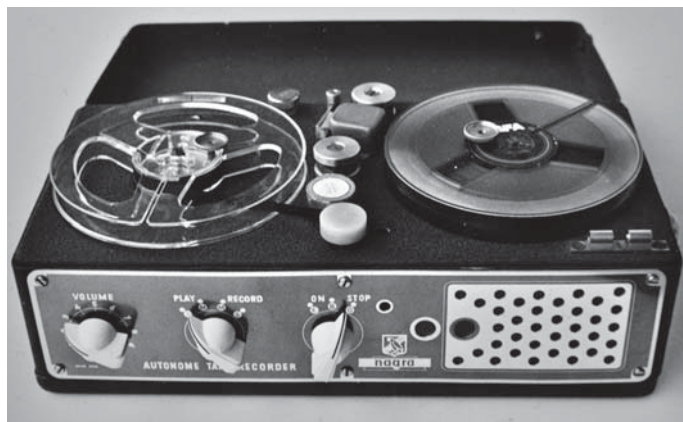
Uhrwerksmotor mit Fliehkraftregelung: Nagra I
