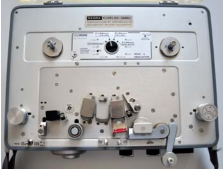
Noch ohne Band: Links und rechts sind die Abgleichpunkte für die verschiedenen Geschwindigkeiten zu erkennen
